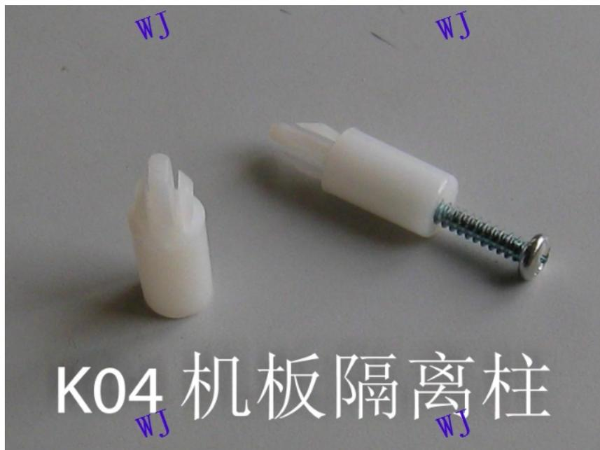
无锡伟哲配线器材有限公司向您介绍我司正在销售的隔离柱：实际应用中，根据电路板的使用情况，还有多隔层隔离柱和异形隔离柱，一般需要根据工程师的要求进行订制，隔离柱产品多使用精密塑胶模具注塑而成。平底隔离柱：基板不开孔，隔离柱底部通常是六角头或者螺纹孔，可以直接安装在基板上的固定槽上，另一端以飞机头扣紧PC板。双头隔离柱：线路板上下均开一孔，隔离柱二端分别插入此孔，凭借飞机头的造型扣紧线路板。圆底隔离柱：一端开较大的孔，一端较小，安装时隔离柱整体从大孔穿入，底部因直径较大不能通过而紧锁于基板之上；另一端以飞机头扣紧PC板。壁虎隔离柱：因头形较尖形似壁虎得名，基板以螺纹孔（一般是3MM）拧紧，另一端以飞机头扣紧PC板。卡式隔离柱：二端造型几乎对称PC板和基板开孔保持一致，分别扣紧PC板和基板。如遇需要购买隔离柱可向无锡伟哲配线器材有限公司询价，可按照客户的要求进行定制，我们将竭诚为您提供一条龙及周到的服务！连云港全国供应隔离柱哪家便宜全国隔离柱供应质量厂家——无锡伟哲配线器材有限公司莅临指导。
